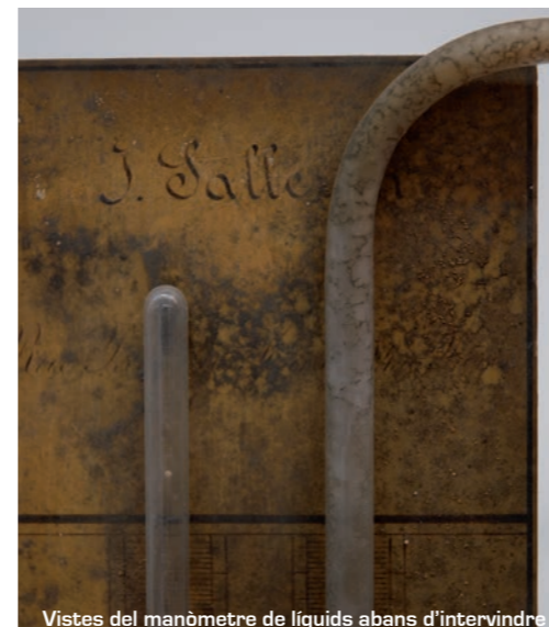
Vistes del manòmetre de líquids abans d'intervindre
