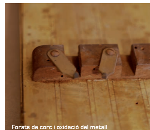
Forats de corc i oxidació del metall
