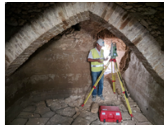
Control topogràfic d'un antic dipòsit annex a la carretera TP-2031, a l'Argilaga.
