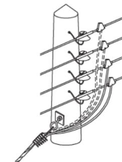
**NOTA:** Este tipo de acometida, tanto monofásica como trifásica, está limitada a un máximo de 20 m de vano
