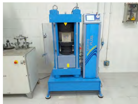
Determinació de la resistència a compressió de provetes cúbiques
