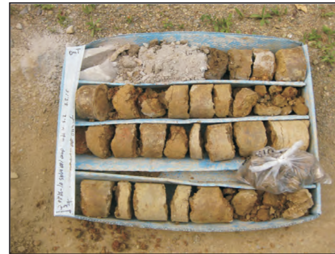
Sondeig S-2. Caixa 0,0 a 3,0 m
