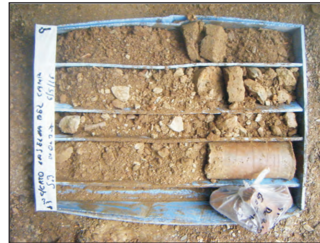
Sondeig S-3. Caixa 0,0 a 3,0 m
