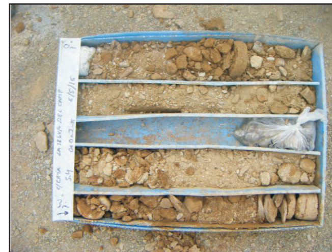
Sondeig S-3. Caixa 0,0 a 3,0 m
