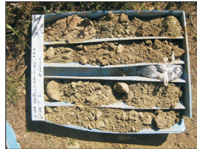
Sondeig S-1. Caixa 0,0 a 3,0 m
