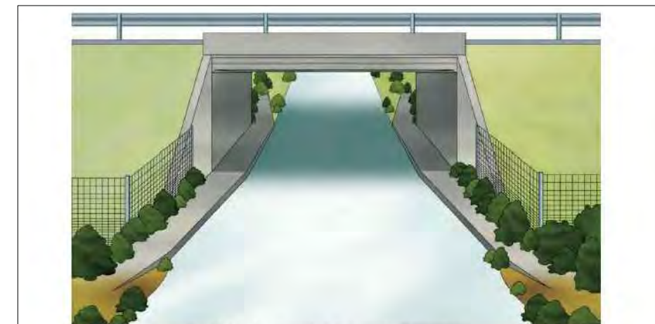
Figura 9.1 – Esquema general d'un drenatge adaptat per a animals terrestres.
